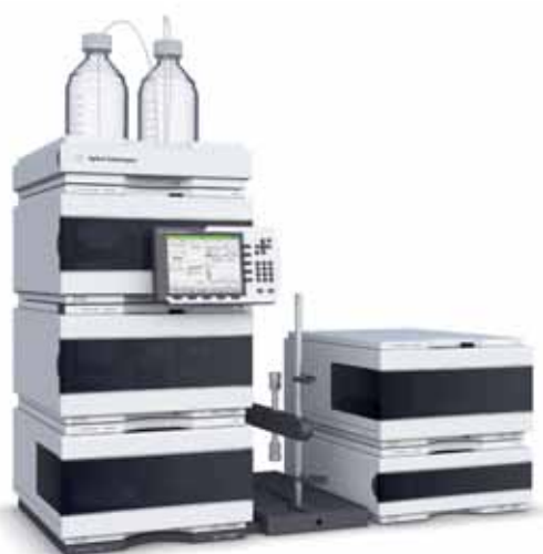
УФ-система препаративной очистки для сбора фракций в количестве от миллиграммов до граммов.
