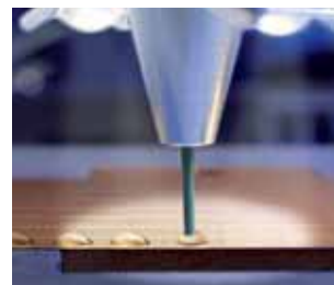
Нанесение микрокапель на мишени для МАЛДИ.
