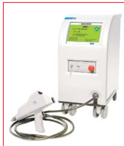
Рис.1. Мобильный Рамановский спектрометр Agilent Rapid позволяет идентифицировать сырье даже сквозь непрозрачную упаковку
